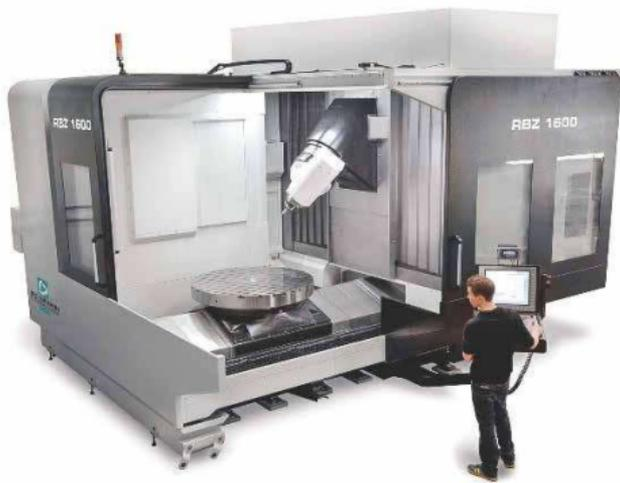
*Komplett-Bearbeitung: Das 5-Achs-Bearbeitungszentrum RBZ 1600 mit integrierter Drehfunktionalität und Schwenkkopf erlaubt das Drehen, Fräsen und Bohren in einer Aufspannung.*
