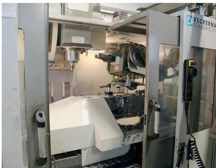
Solide Alternative zu HSC: Für die Reckermann-Maschine spricht die Robustheit, die sie dem Einsatz solider High-Torque-Cutting-Riemenspindeln verdankt.
