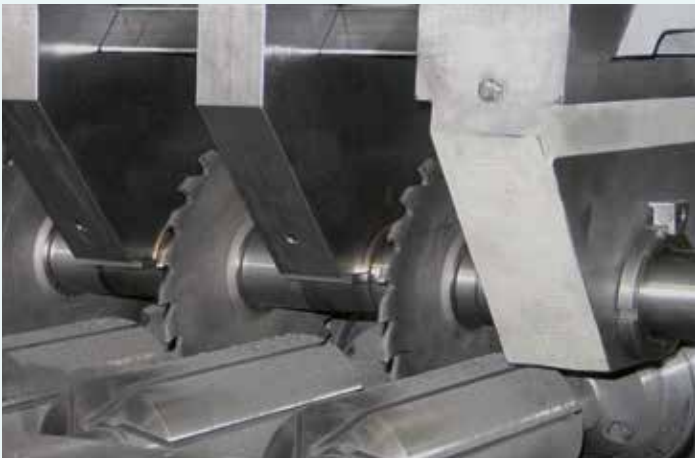
Schlitzen von Rotoren für Vakuumpumpen im Paket
