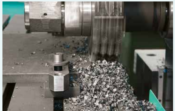
Fräsen eines Führungsrasters in Platten aus Hasteloy
