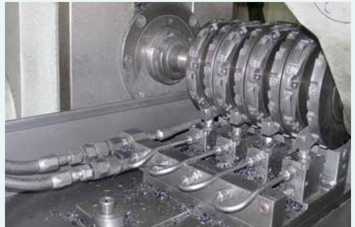
Bearbeitung der Enden von Lenkstangen
