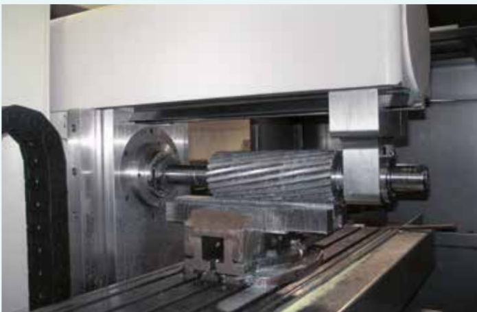
Fräsen von Zähnen in mehrere Sägeblätter im Stapel
