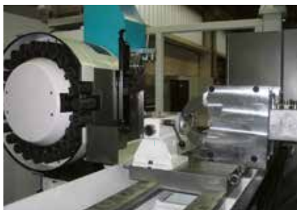
Fräsen von Nuten in Wellen mit einer Länge von bis zu 2.600mm
