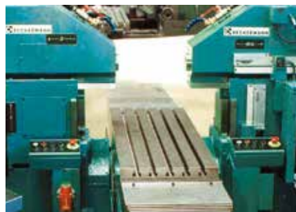
Bearbeitung von Maschinenmessern im Pendelbetrieb X 2.300, Y 1.000, Z450 1.050 Nm
