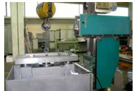
Stirnseitige Bearbeitung von Wellen mit Wendeeinrichtung
