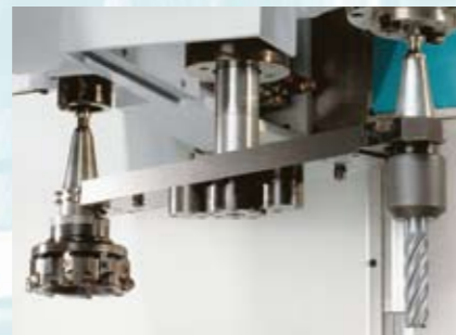
Werkzeugwechsel mit schnellem Doppelarmgreifer
